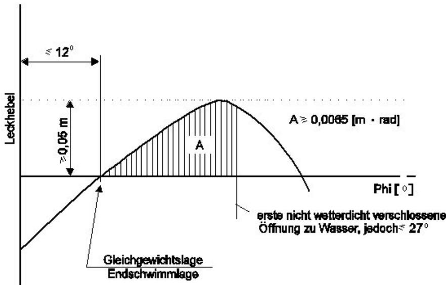
(3) Binnenschiffe mit ungesicherter Containerladung haben folgende Leckstabilitätskriterien einzuhalten:
