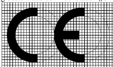
Bei Verkleinerung oder Vergrößerung der CE-Kennzeichnung müssen die sich aus dem oben abgebildeten Raster ergebenden Proportionen eingehalten werden.
